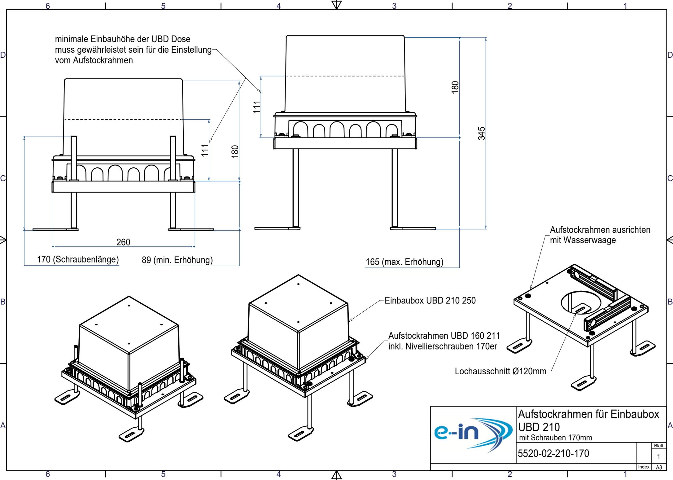
minimale Einbauhöhe der UBD Dose muss gewährleistet sein für die Einstellung vom Aufstockrahmen
