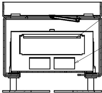
Unterlagsboden darf Höhe 180mm nicht überschreiten, ansonsten muss ein Aufstockrahmen verwendet werden
