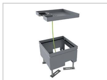
**Mise à la terre:** Les boîtes de sol doivent être installées et montées dans les règles de l'art. Tous les éléments métalliques conducteurs doivent être reliés entre eux et être cheminés vers un point. Un fil de terre est déjà préinstallé sur le dessous de la boîte de sol et n'a plus qu'à être connecté avec le couvercle.
