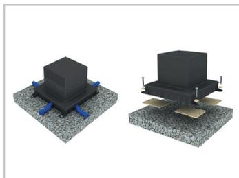
**1.** Monter la boîte encastrée avec les 4 trous préperçés sur une surface solide (non recommandé sur l'isolation). Percer ou casser au  $\varnothing$  voulu les passages de tubes latéraux et mettre les tubes en place. Fixez bien les tubes d'installation sur le sol avant d'entrer dans la boîte encastrée. Utiliser éventuellement une protection contre les bruits de choc pour la boîte
