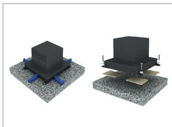
**1.** Einbau-Box mit den 4 vorbereiteten Bohrlochern auf festem Untergrund (nicht zu empfehlen ist auf Isolation) montieren. Entsprechender Rohrdurchmesser für die seitlichen Rohreinführungen ausbrechen/bohren und die Rohre hineinschieben. Installationsrohre kurz vor Eintritt in die Einbau-Box gut auf dem Boden befestigen. Evtl. Trittschall-Unterlage für Einbau-Box verwenden.
