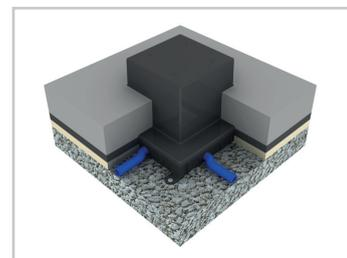
**3.** Bei einem gegossenen Fertigboden, Teppich, Linoleum oder ähnlichem Bodenbelag empfehlen wir keinen Stellstreifen rund um die Einbau-Box zu verlegen. Allenfalls würde beim gegossenen Fertigboden ein zu breiter Silikonstreifen entstehen, resp. beim Teppich oder Linoleum der Rand zur Dose instabil werden.
