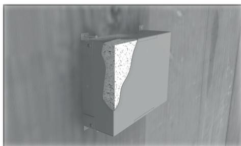
1. Si le boîtier est monté dans un mur en maçonnerie, les languettes peuvent être posées sur le mur. Le cache doit être de 25mm maximum, sinon le cadre de visualisation ne peut pas être fixé avec les boulons de fixation latéraux.
