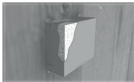
1. Wird das Gehäuse in ein Mauerwerk o.ä. eingebaut, können die Laschen auf dem Mauerwerk aufliegen. Der Überzug darf max. 25mm sein, ansonsten kann der Sichtrahmen mit den seitlichen Befestigungsbolzen nicht fixiert werden.
