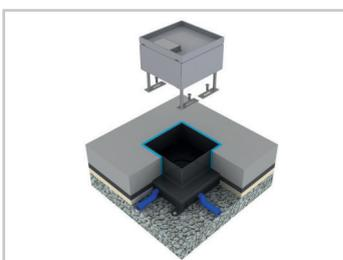
**6.** Nivellierschrauben in die Bodendose einschrauben. Bodendose in die Aussparung einlegen. Die Nivellierschrauben an den vorgesehenen Stellen anschrauben.
