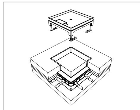
6. Bodendose in die Aussparung einlegen. Für die Befestigung der Nivellierschrauben je ein Loch in den Rohboden bohren und befestigen. Evtl. Trittschall-Unterlage für Nivellierfüsse verwenden.
