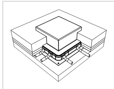
3. Bei einem gegossenen Fertigboden, Teppich, Linoleum oder ähnlichem Bodenbelag empfehlen wir keinen Stellstreifen rund um die Einbaubox zu verlegen. Allenfalls würde beim gegossenen Fertigboden ein zu breiter Silikonstreifen entstehen, resp. beim Teppich oder Linoleum der Rand zur Dose instabil werden.
